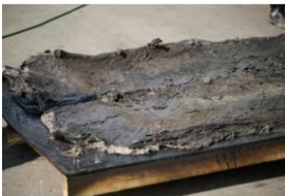
Figur 10. Prov med EPS där EPS har smält bort helt.
