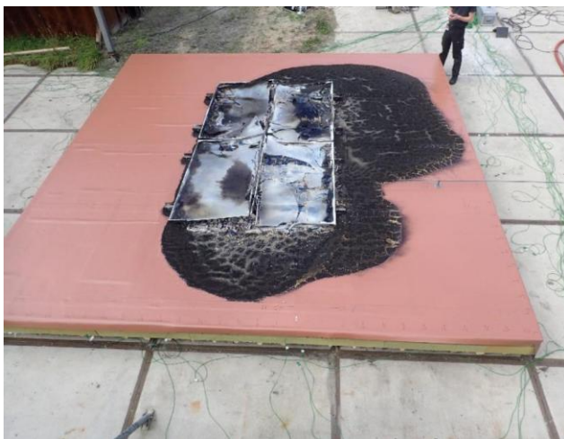
Figur 18. Översikt över bränt tak med mineralull.
