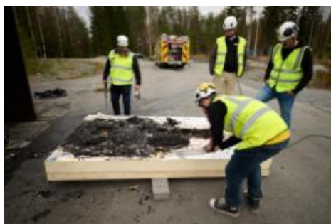
Figur 10. Prov med EPS där EPS har smält bort helt.
