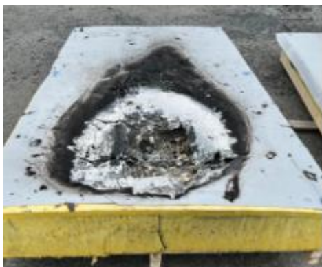
Figur 12. Prov med glasull.
